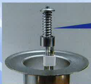
トリウムタングステンフィラメント (Thorium tungsten filament)
